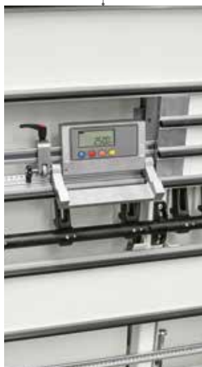
Digitale Maßanzeige für vertikale Schnitte (Opt. v, vs, vsi)
