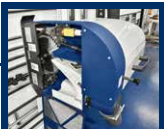
Doppel-Sägeblattvorritzer mit eigenem Motor
