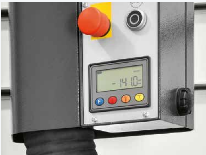
Digitale Maßanzeige für horizontale Schnitte
