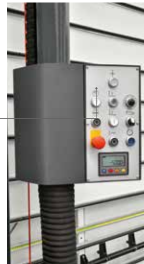
Digitale Maßanzeige für horizontale Schnitte (Opt. v, vs, vsi)
