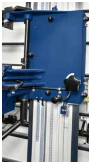
Metrische Maßstab für horizontale Schnittmaße (std. v, vs, vsi)
