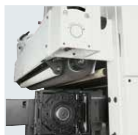
Gruppo satinatore oscillante e gruppo strutturatore in uscita al piano per finiture esclusive.
