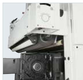
Gruppo satinatore oscillante e gruppo strutturatore in uscita al piano per finiture esclusive.
