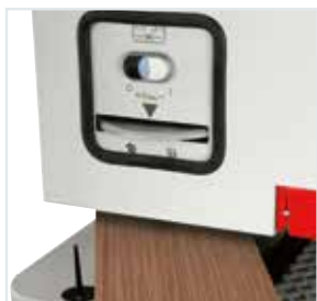
Posizionatore automatico del piano: rilevazione automatica dello spessore del pezzo per lavorazioni rapide e precise.
