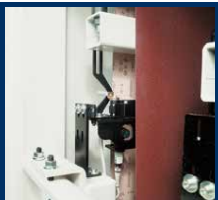
Fotocellula oscillazione nastri per una maggiore vita del nastro.
