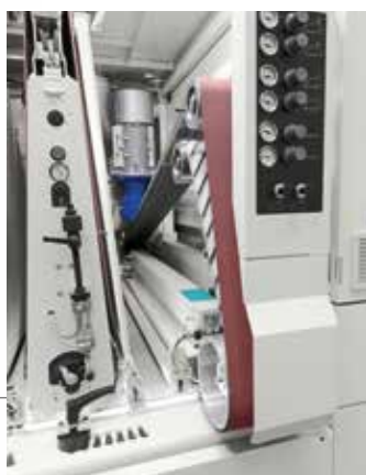
Gruppo trasversale interno estraibile con sviluppo 5000 mm
