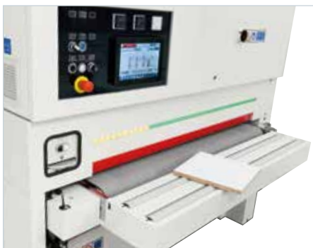
Sequenziatore introduzione pannello per ridurre i costi di gestione macchina.
