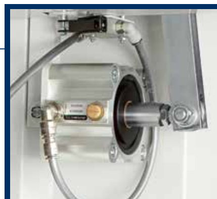
Centraggio automatico del tappeto per una maggiore vita del nastro trasportatore.
