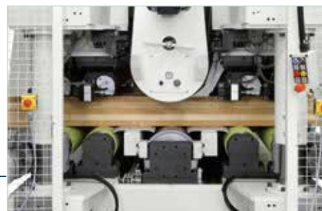
Ampia apertura del piano di lavoro per la lavorazione di pareti fino a 500 mm di spessore.
