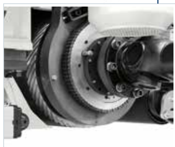
Rullo calibratore in acciaio scanalato di 450 mm di diametro.
