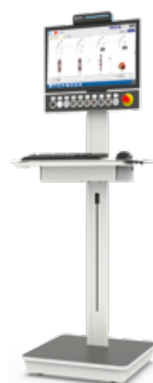
Consolle eye-M con controllo elettronico Maestro active sand, per un controllo rapido ed efficace della macchina "Maestro active sand" permette di impostare dalla consolle eye-M con touch screen da 24" tutti i parametri di lavorazione, per una gestione semplice e immediata della macchina e dell'intero processo produttivo.
