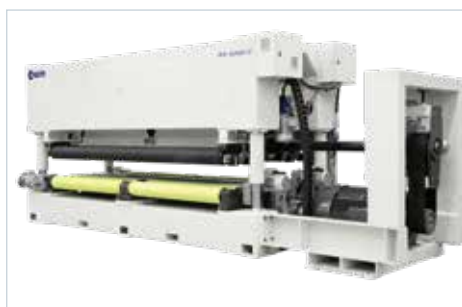
Operazioni di installazione e manutenzione facilitate, con i motori posizionati a terra.
