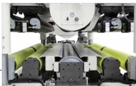
Piano inferiore a rulli di grande diametro (210 mm) in Vulkollan con motorizzazioni indipendenti gestiti da HMI, per garantire una velocità identica per ogni rullo.
