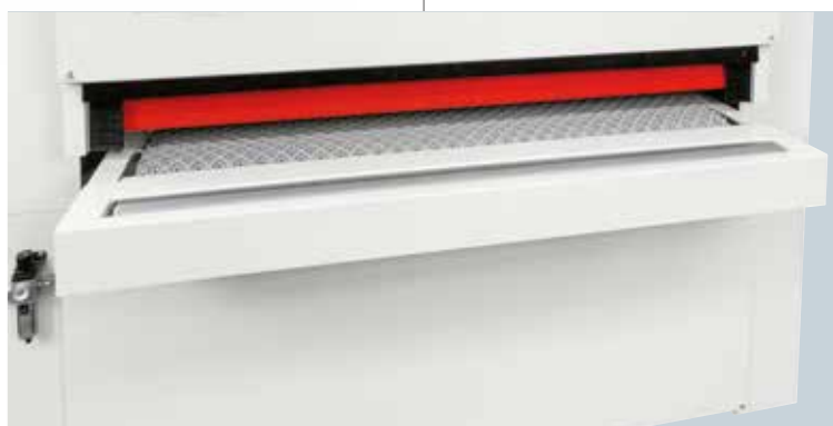
Tappeto ad anello chiuso in gomma per una migliore trazione del pezzo.
