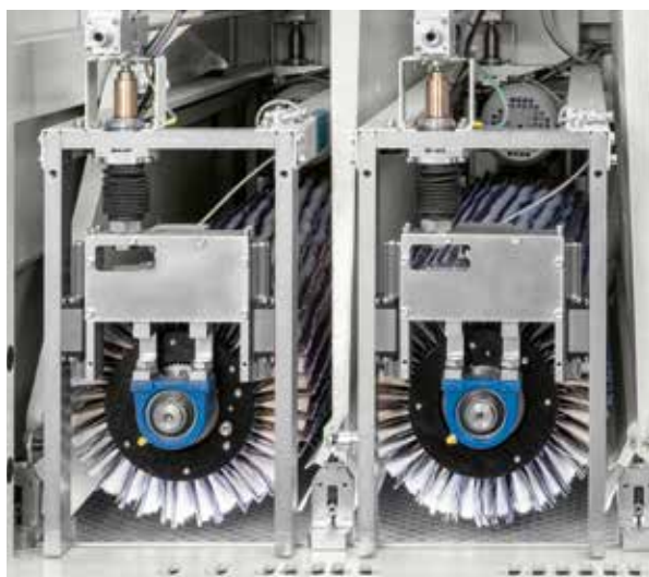
Gruppo spazzola oscillante con doppio senso di rotazione per abrasivi bifacciali, disponibile con abrasivi Simoni e Flextrim.
