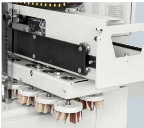
Nessuno tempo morto Gruppo a dischi estraibile con movimento traslante e sistema di cambio rapido degli utensili.
