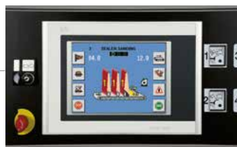
Controllo Pro-sand per gestire da touch-screen il posizionamento automatico dei gruppi.
