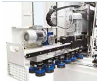
Gruppo Planetario: levigatura multi-direzionale per il massimo della finitura.
