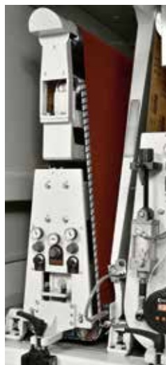
Gruppo Superfinitore con sviluppo nastro 2620 mm.
