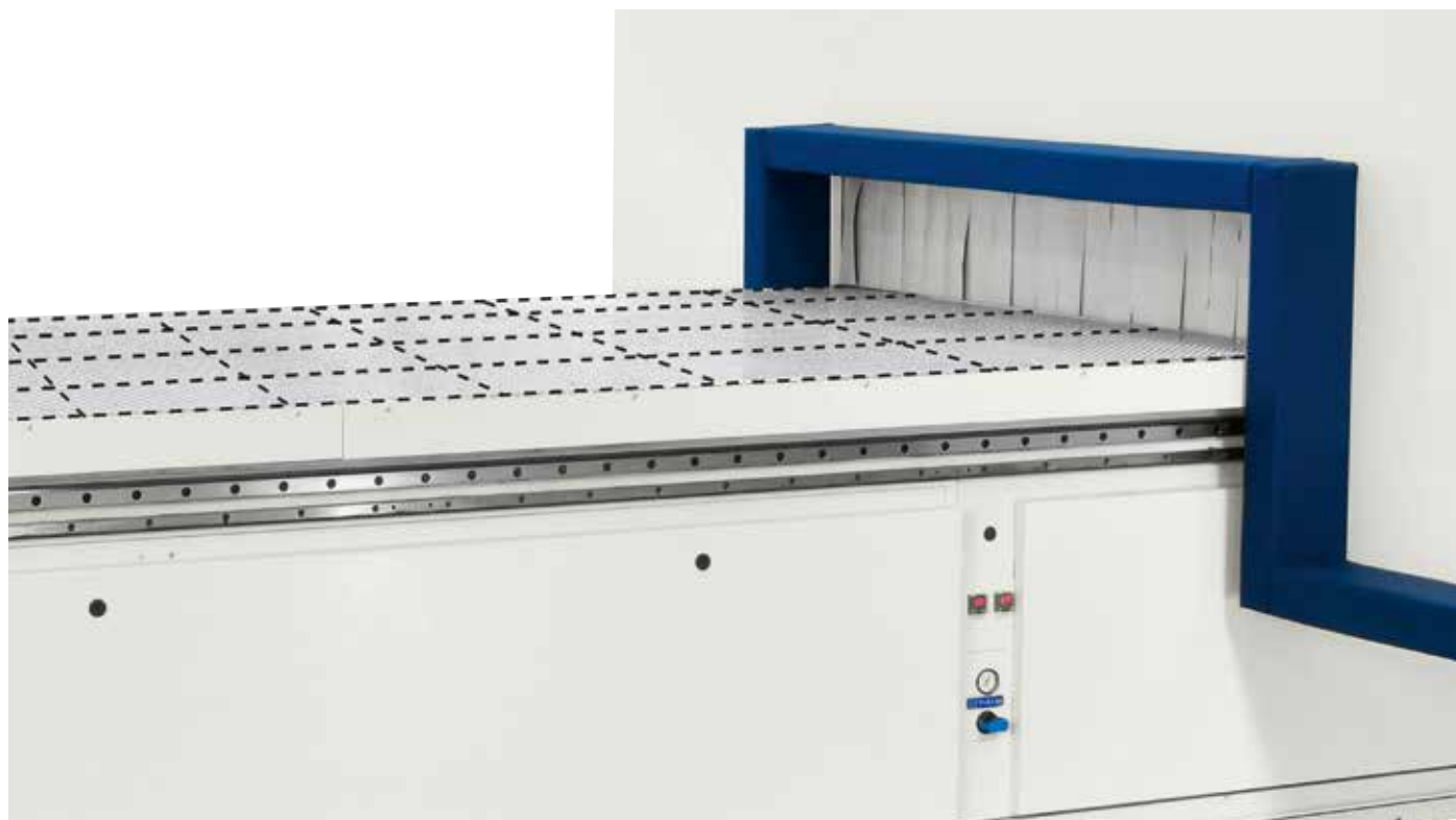
仅在必要时，最大限度地保夹工件：根据加工台的尺寸，可用从2到30个真空区。
