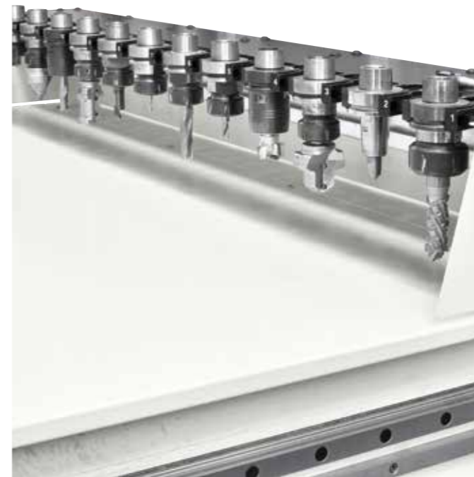
Seitliches Magazin TRB mit bis zu 19 Positionen.
