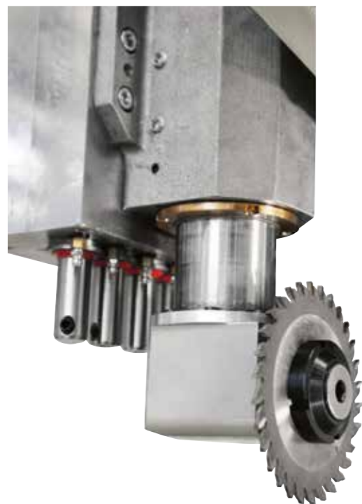
Einfache Ausführung von Schnitten oder Einkerbungen in X- und Y-Richtung mit der Blatteneinheit 0°-90°.
