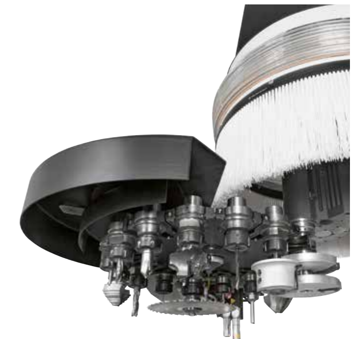
Viele Werkzeuge stehen dank des hinteren Magazin R16 immer zur Verfügung.
