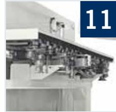
*Des cycles d'usinage plus rapides avec le magasin FAST à 14 positions ancré dans les poutres.*
