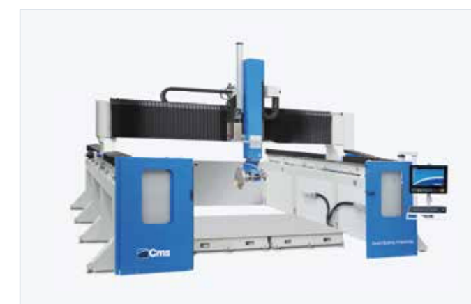
Версия с открытой рамой, для установки на бетон.
