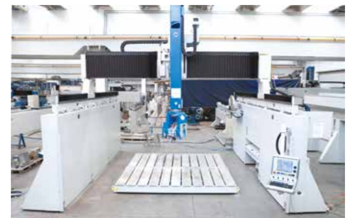
Z轴行程高达2000毫米，保证厚度极高的工件加工
