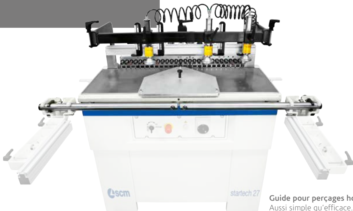
Groupes pour charnières Pour des machines encore plus polyvalentes, il est possible de monter sur les mandrins plusieurs types de têtes optionnelles en mesure de réaliser des logements pratiques pour charnières.
