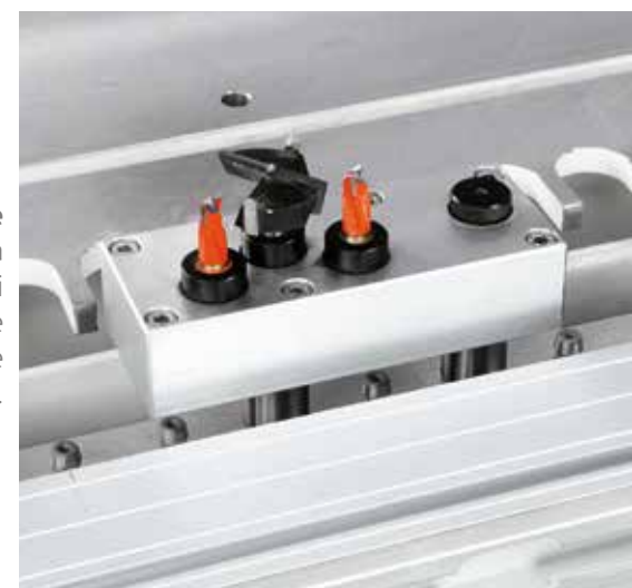
Gruppi per cerniere Per una maggiore polivalenza della macchina, è possibile equipaggiare i mandrini con varie tipologie di testine opzionali in grado di realizzare delle pratiche sedi per cerniere.
