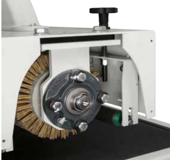
Mise au point simple Réglage rapide des rouleaux presseurs grâce à des poignées dédiées.
