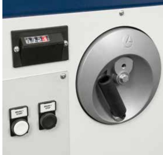
Facilité d'utilisation Soulèvement des groupes opérateurs grâce à des volants avec un indicateur numérique.
