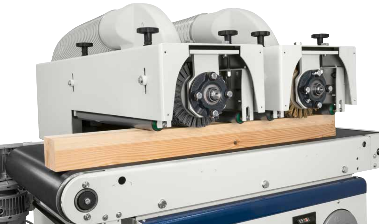
Mise au point simple Réglage rapide des rouleaux presseurs grâce à des poignées dédiées.
