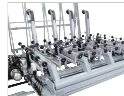
Caricatrice fissa o mobile, con singola o doppia stazione, per il carico automatico delle lastre di vetro poste in verticale
