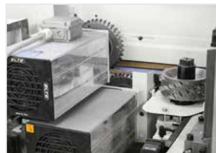
Gruppo di fresatura pannello: Doppio truciolo e antisceggia compatto per una maggior precisione di lavorazione.
