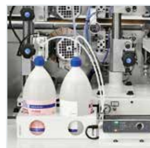
Vari liquidi nebulizzati per una migliore finitura dei bordi in relazione alle tipologie degli stessi e dei pannelli.
