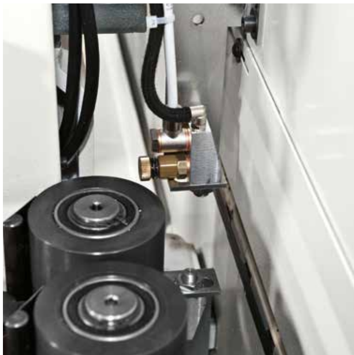
Liquido per raffreddare la temperatura della colla nella zona di esubero bordo, dopo bordatura, al fine di mantenere puliti gli utensili delle lavorazioni successive.
