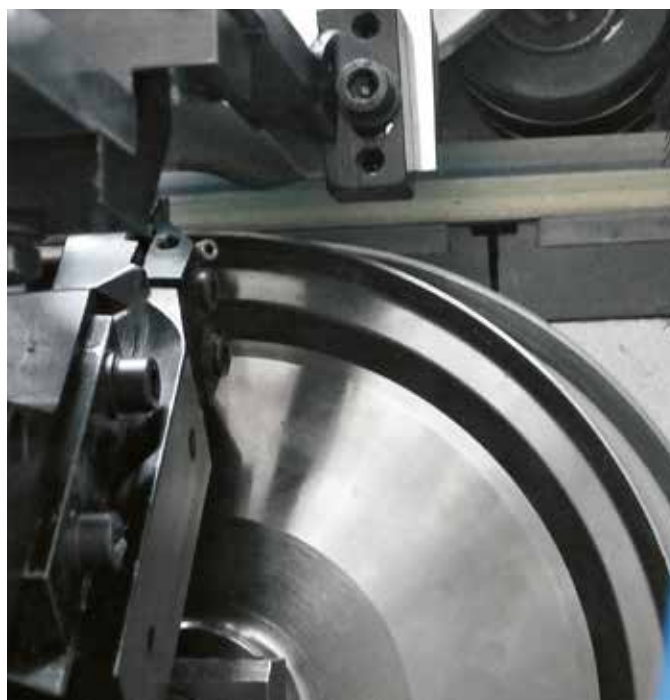
Sistema di copiatura Twin Feeler che consente una lavorazione costante e priva di segni soprattutto alle alte velocità.
