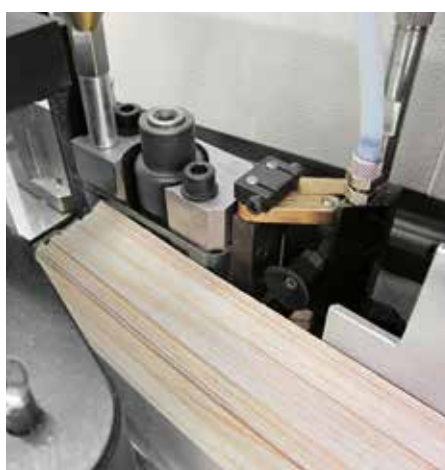
Lavorazione bordi in striscia pretagliata in impiallacciatura o plastica rigida (unicolor, formica, PC).
