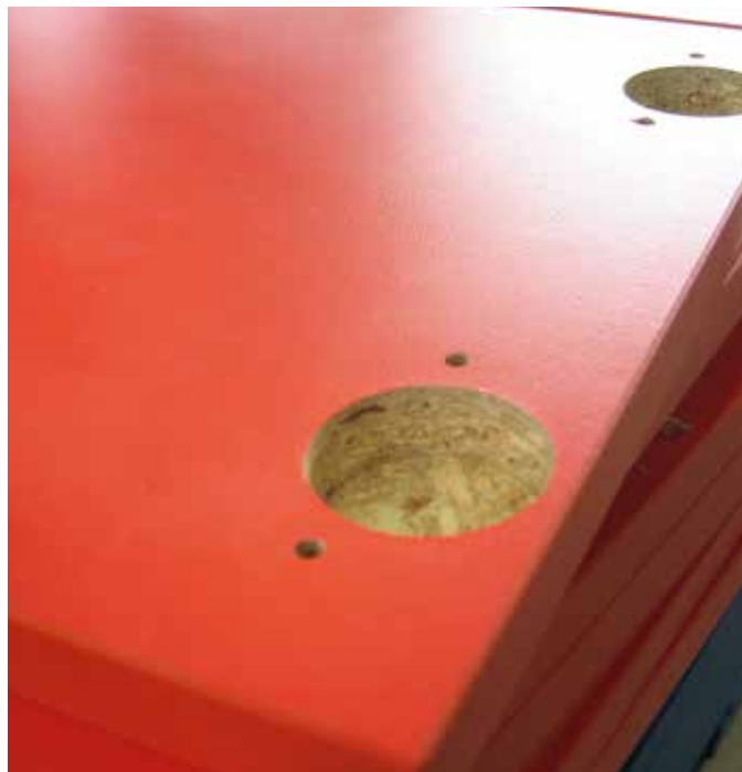
Set-Up automatico da HMI quando presente il foro da nesting
