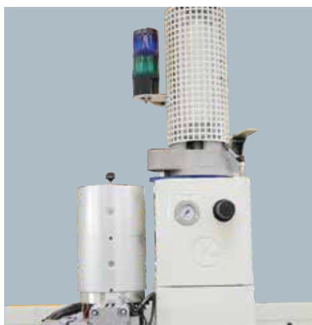
Cambio veloce del tipo di colla utilizzata da EVA a PU o viceversa, con la selezione manuale del tipo di prefusore impiegato.
