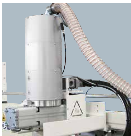
Prefusore QMS-P Per la prefusione fino a 8.5 Kg/h di colla EVA in granulo. Rapida intercambiabilità per cambio colore con sgancio rapido della tramoggia.
