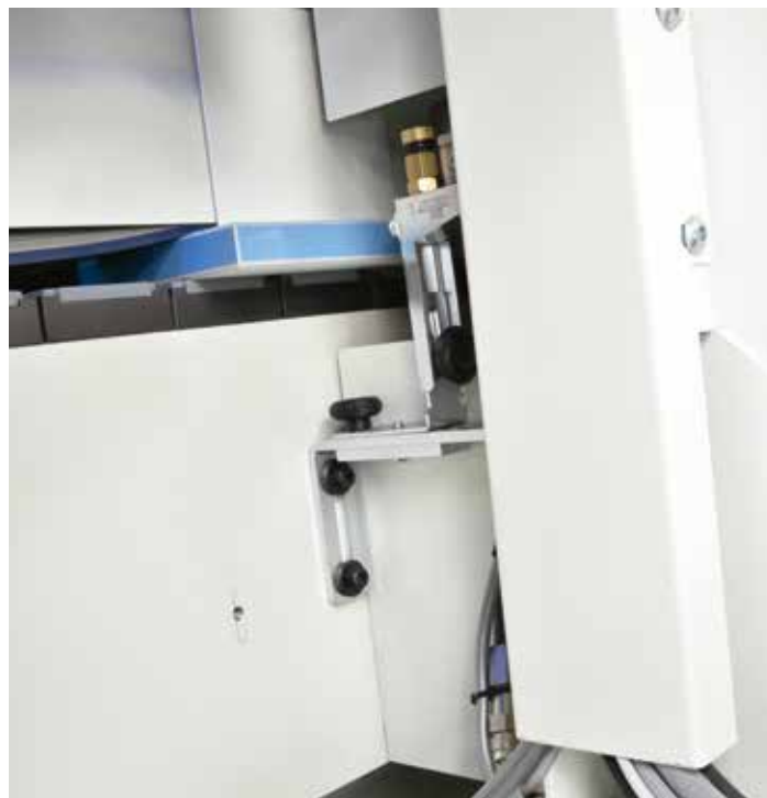
Liquido scivolante adatto alla lavorazione di bordi delicati o con pellicola protettiva.
