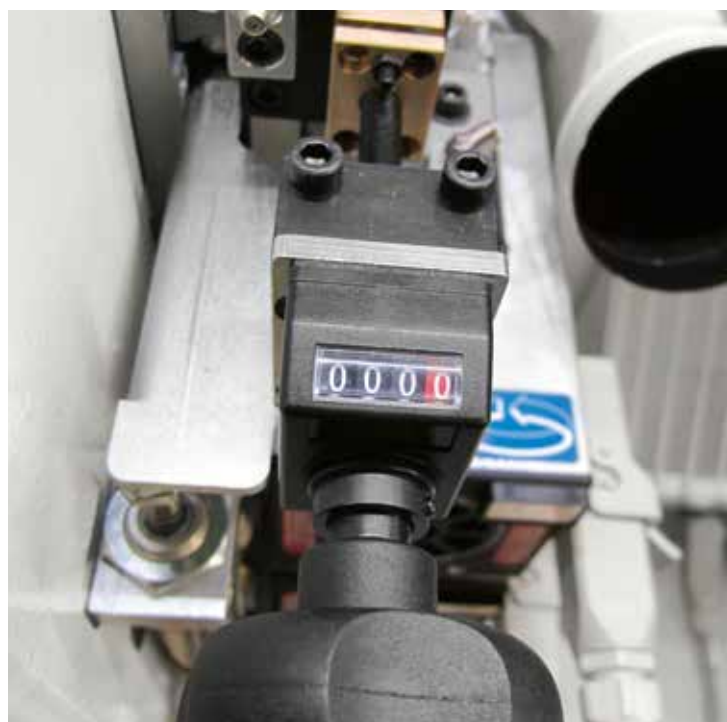
Regolazione orizzontale posizione motore con indicatore numerico decimale.
