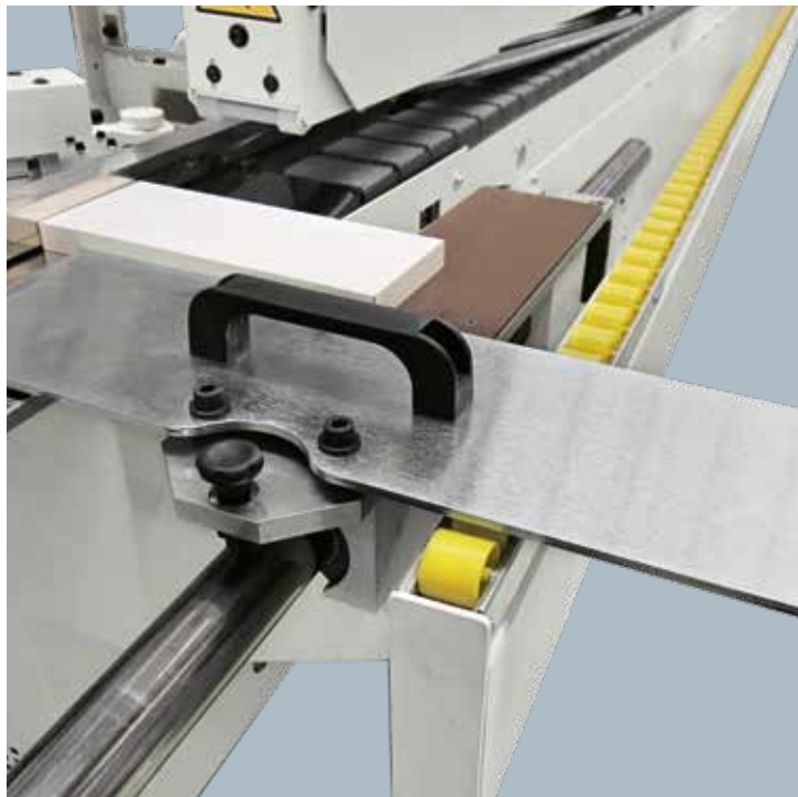
Massima precisione di lavorazione anche con i pannelli stretti/cassetti grazie all'introduttore manuale escludibile (opt).
