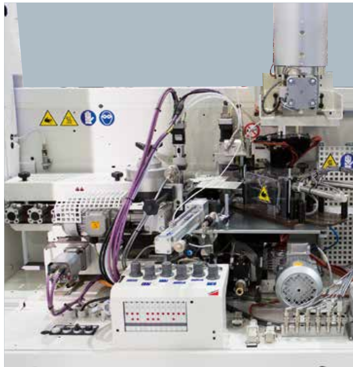
Soluzioni HIGH END per ridurre i tempi di lavorazione. Guida bordo CN (opt). Dosaggio CN (opt). Zona pressione CN (opt).
