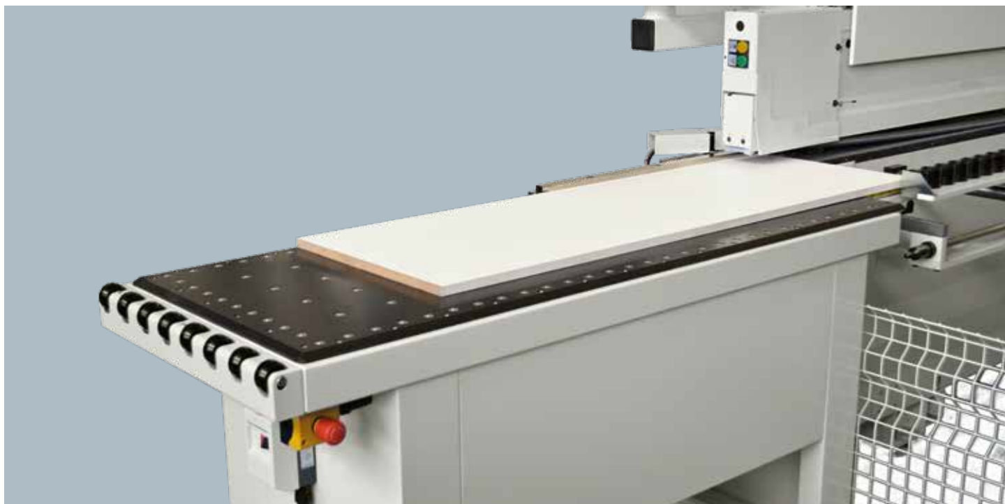
Movimentare abilmente i pannelli nella zona di carico è semplice e veloce con il banco a velo d'aria (opt.)
