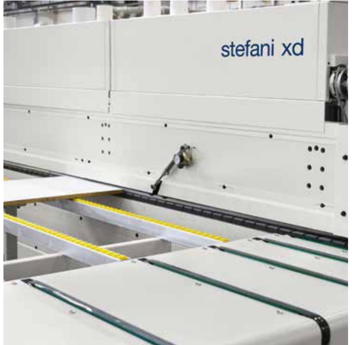
Transfer in uscita pannello multcinghia (opt). Sostegno pannelli fisso (opt).
