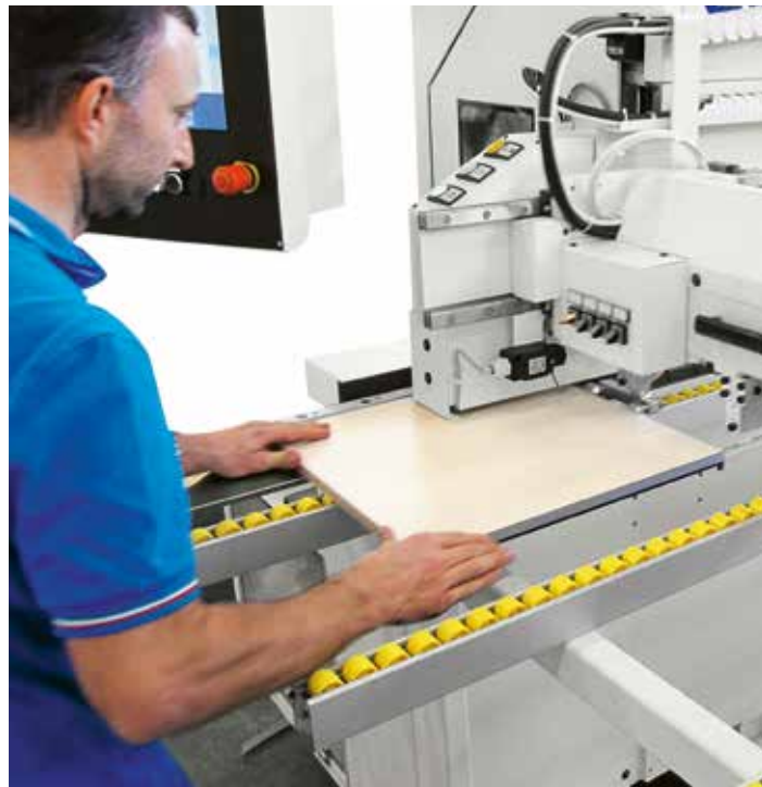
Introduttore manuale Easy Order M per introdurre agevolmente e senza errori i pannelli ortogonalmente al senso di avanzamento fino a dimensioni 2.200 mm x 1.200 mm (opt).
