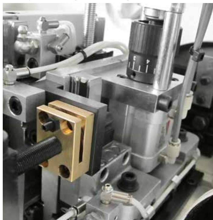
Doppia posizione automatica verticale da HMI per la lavorazione del bordo in plastica od in legno (std). Microregolazione battuta manuale.
