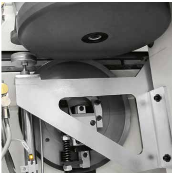
Sistema di controcopiatura aggiunta a disco di grande diametro nel caso di lavorazione di pannelli con ridotto spessore con tendenza a piegarsi.
