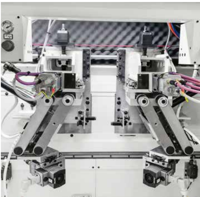
Gruppo arrotondatore C3 specifico per l'arrotondatura angolo porta su tre o quattro lati.
