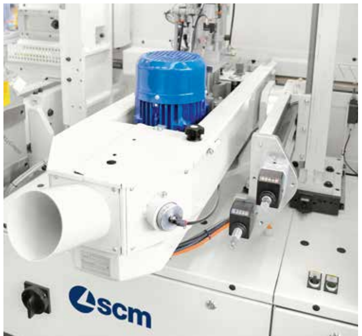
Gruppi levigatori per la finitura della porta bordata con bordo in impiallacciatura.
