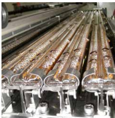
Lampade ad alta potenza con tecnologia ad Onde Corte.
