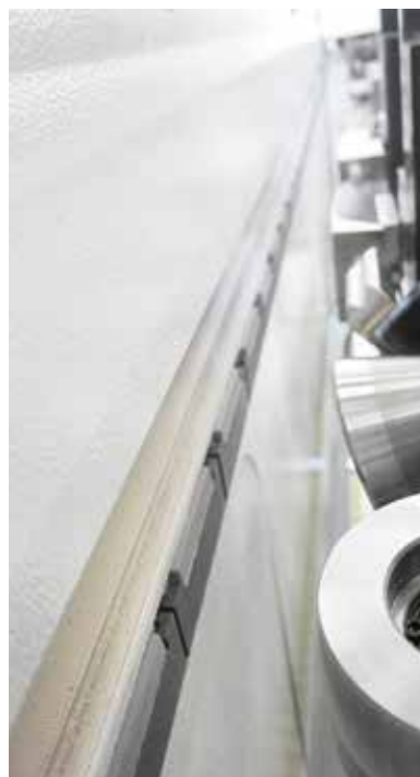
Zona di pressione e sagomatura del bordo specifica per ogni profilo.
