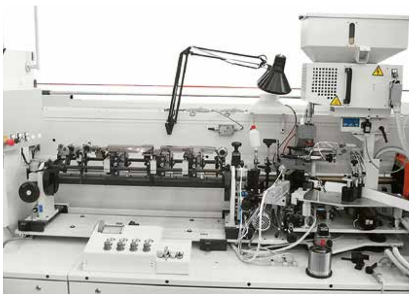
Gruppo incollaggio per la lavorazione di porte con bordi sottili/morbidi.
