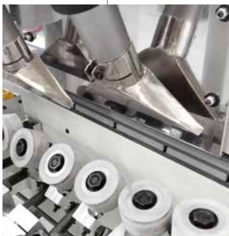
Zona di pressatura bordo di maggiore lunghezza per la corretta piegatura e chiusura del profilo.
