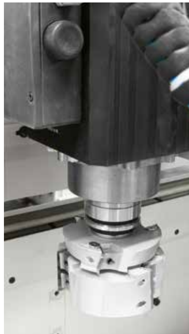
Gruppo profilatore MX80 HSK SOFT con cambio rapido utensile.
