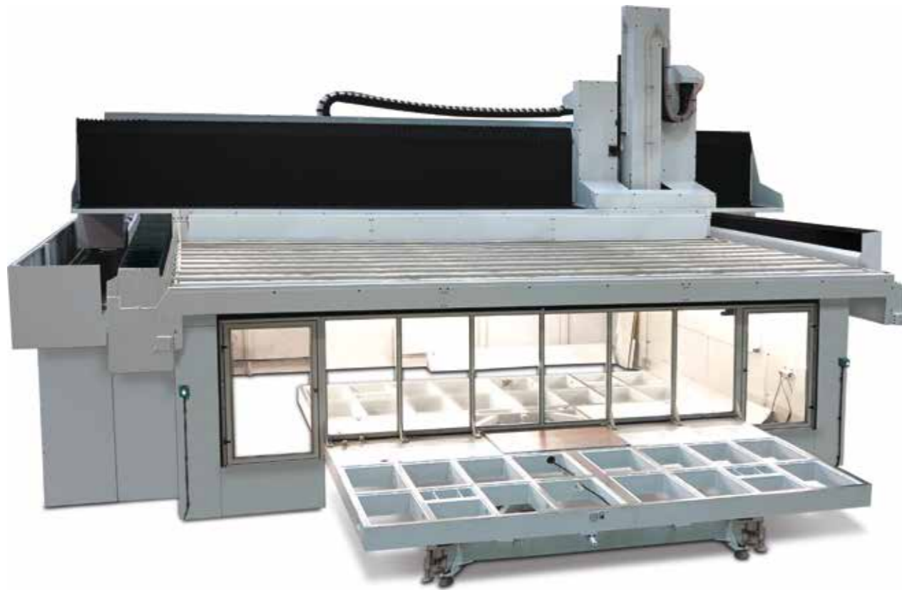
DREHTISCH: ERLEICHTERT DAS BE- UND ENTLADEN AUSSERHALB DER MASCHINE UND ERMÖGLICHT DEN PENDELBETRIEB UNTER AUSNUTZUNG DES GESAMTEN ARBEITSBEREICHS
