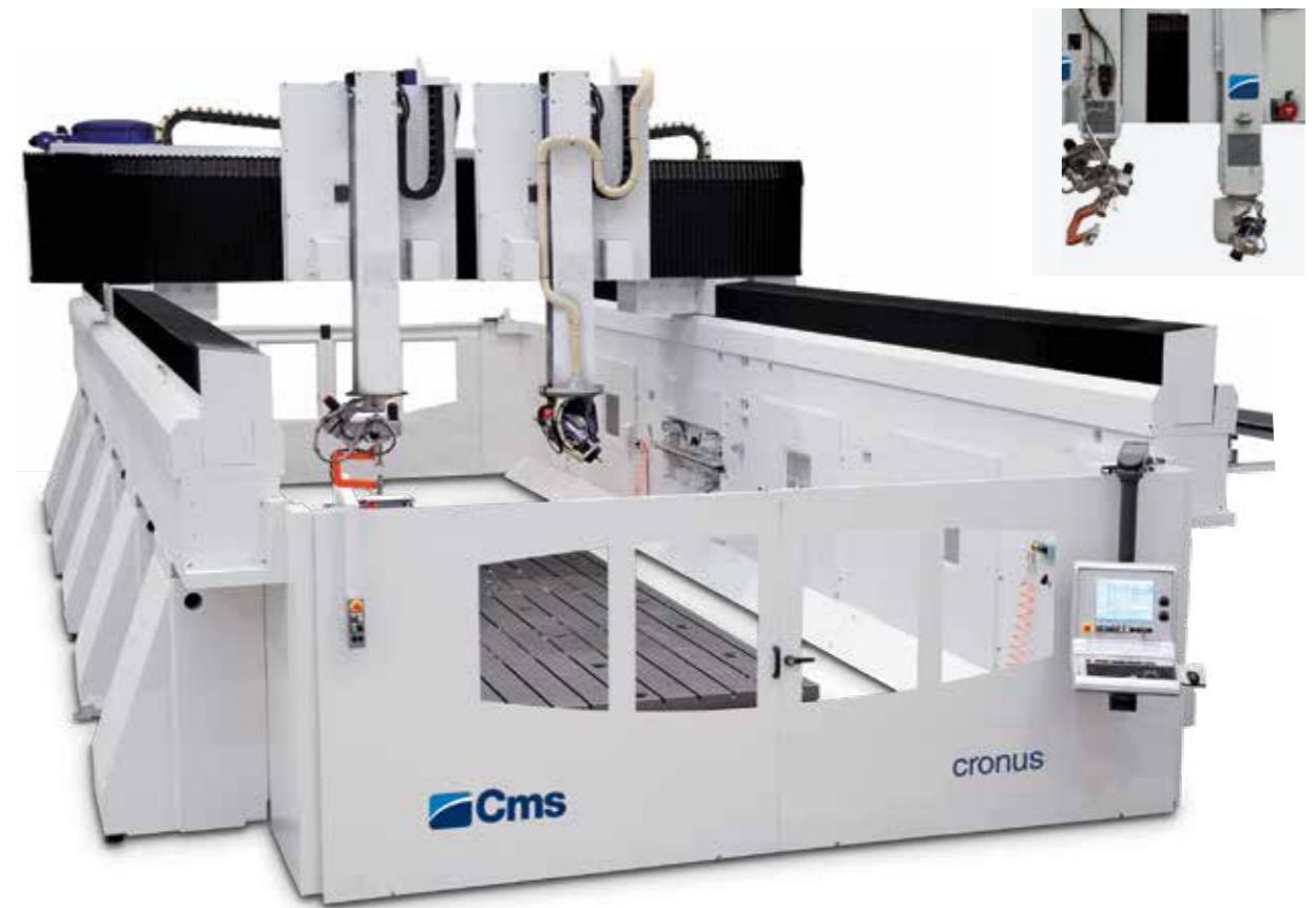
HYBRIDLÖSUNG MIT 5 AXHSEN: FRÄSE + WASSERSTRAHLSCHNEIDER MIT FANGVORRICHTUNG
