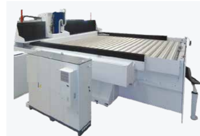
Abschluss auf der Oberseite mit Faltenbalg für die Auffangung von Staub und Spänen.
