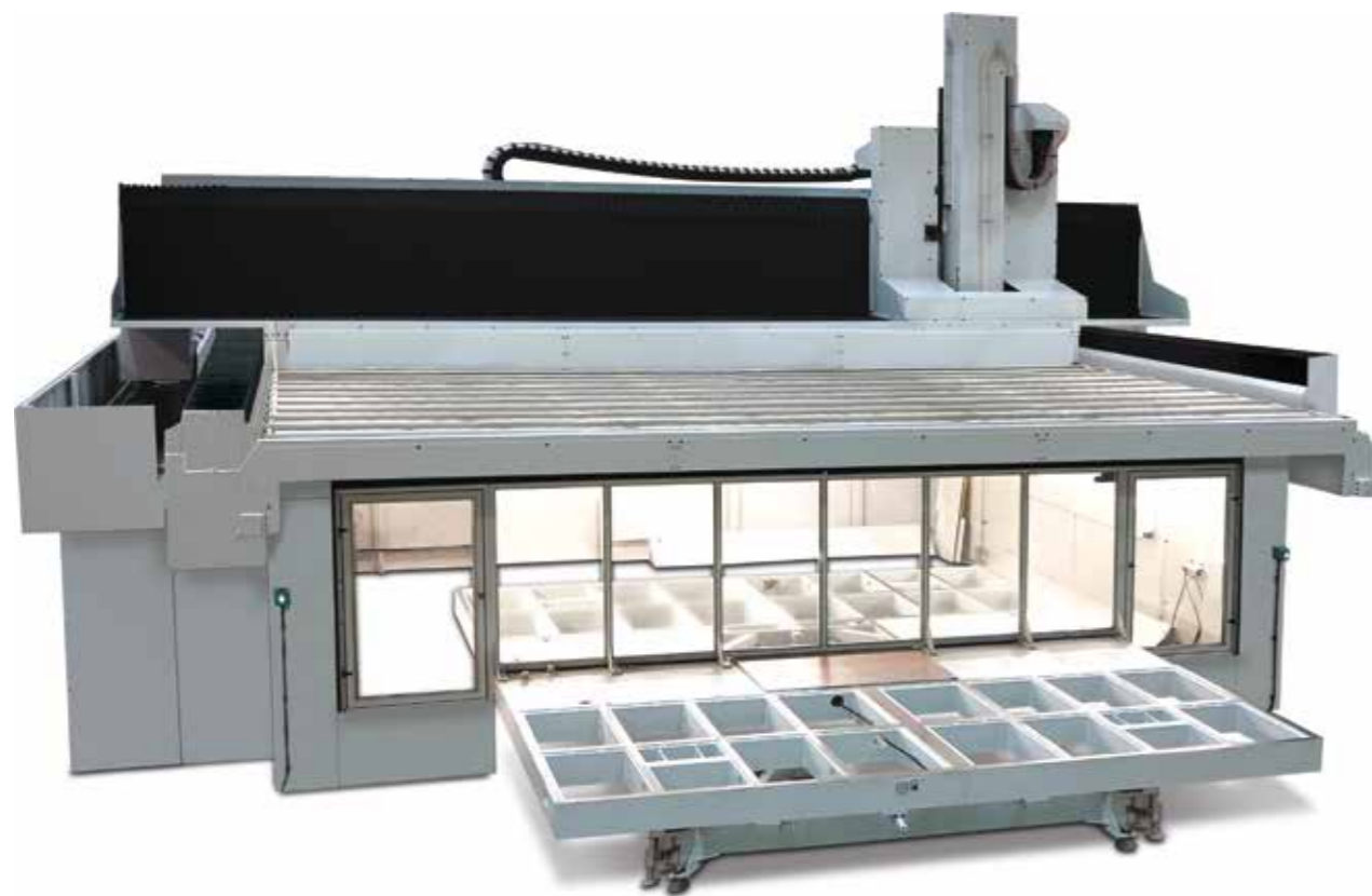
ВРАЩАЮЩИЙСЯ СТОЛ: УПРОЩАЕТ ЗАГРУЗКУ / РАЗГРУЗКУ ВНЕ СТАНКА И ПОЗВОЛЯЕТ ВЫПОЛНЯТЬ МАЯТНИКОВЫЙ ЦИКЛ, ИСПОЛЬЗУЯ ВСЮ РАБОЧУЮ ЗОНУ
