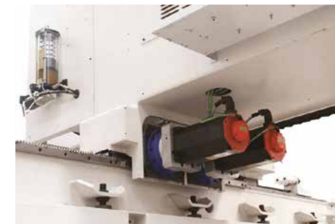
Модель Concept добавляет к превосходным характеристикам модели Poseidon кинематику с электрической выборкой люфта (два двигателя).
