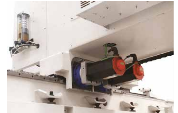
Concept adiciona, ao excelente desempenho de poseidon, a cinemática com recuperação da folga elétrica (motor duplo)
