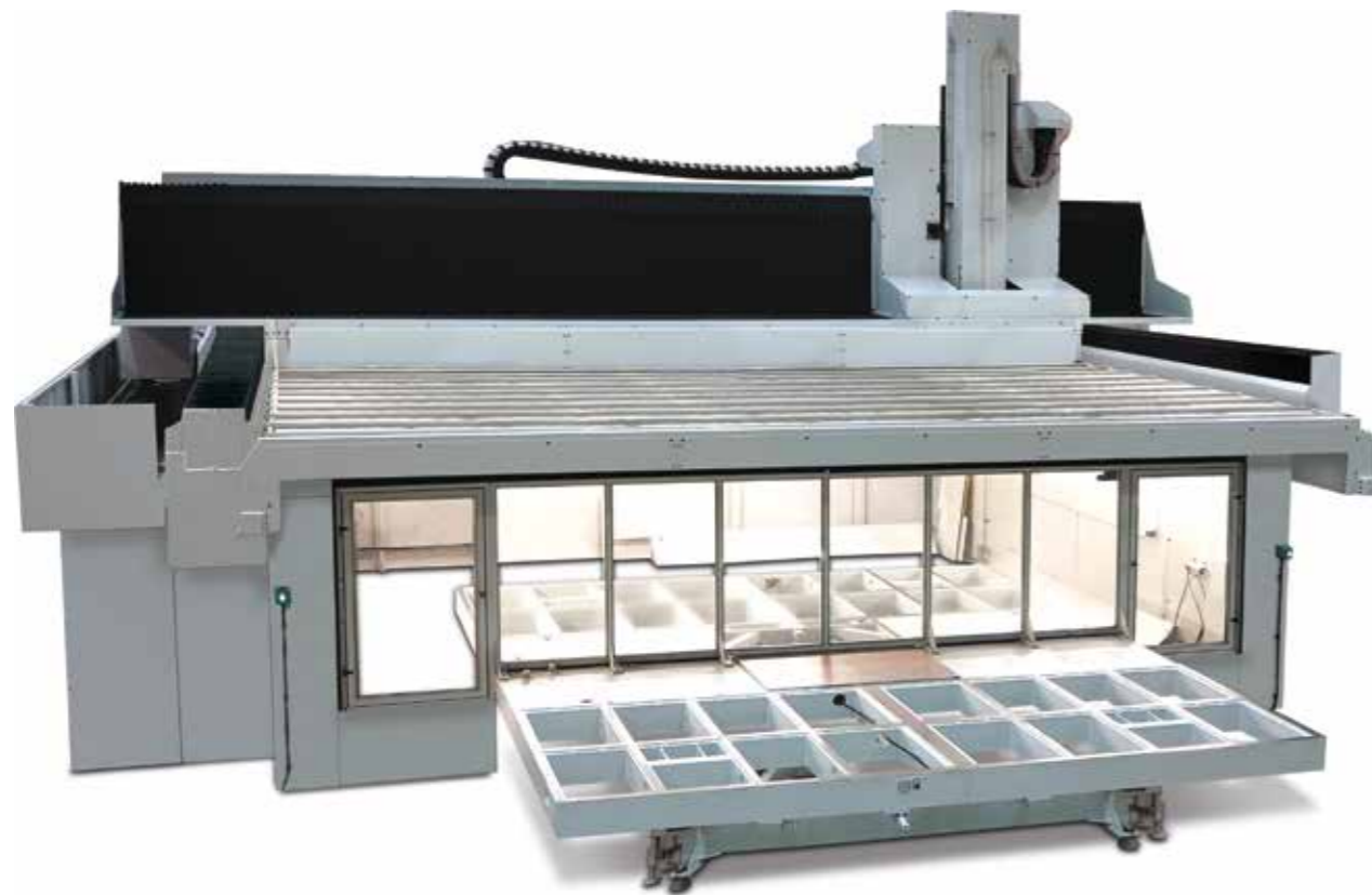
MESA GIRATÓRIA: SIMPLIFICA A CARGA/DESCARGA FORA DA MÁQUINA E PERMITE O CICLO DO PENDULAR USANDO A ÁREA DE TRABALHO COMPLETA
