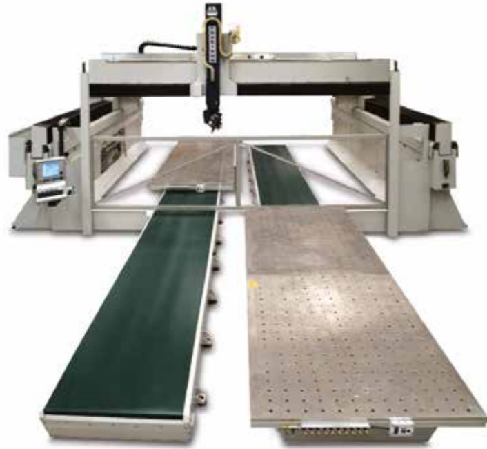
可以在加工区外进行装卸的APC接驳台
