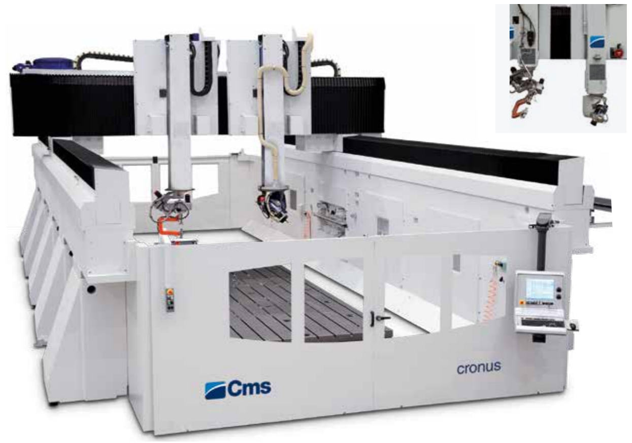
5轴混合解决方案：铣削+带收板装置的水射流切
