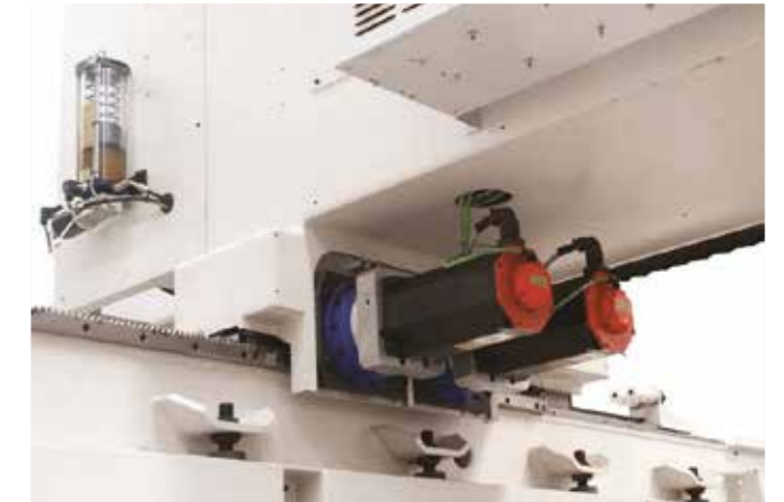
此概念为Poseidon的卓越性能增添了带电动游隙恢复（双电机）的运动学性能
