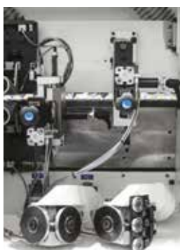
Raschiabordo RAS-A Semplice e rapido cambio del raggio di lavorazione con la sostituzione del kit utensile.
