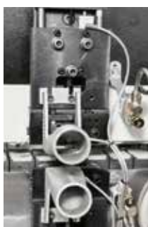
Raschiacolla RC-N Elimina eventuali esuberanti di colla nella giunzione bordo/pannello. Lavorazione nesting.
