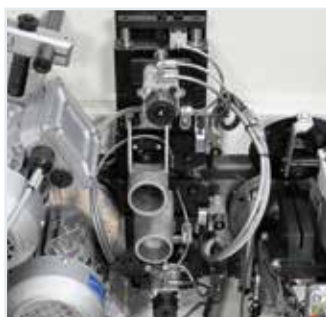
Raschiacolla RC-N Elimina eventuali esuberi di colla nella giunzione bordo/pannello. Doppia posizione pneumatica per la lavorazione di pannelli pellicolati.
