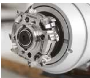
Arrotondatore Round 2-A Gruppo con 2 motori e dispositivo Multiedge per la lavorazione di 2 raggi veri.
