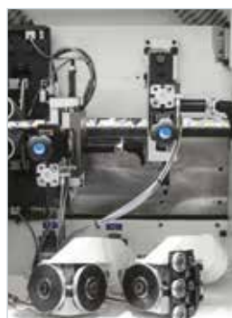
Raschiabordo RAS-A Semplice e rapido cambio del raggio di lavorazione con la sostituzione del kit utensile.
