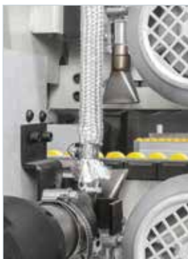
Ravvivatore bordi ID 3000 Ravviva il colore dei bordi plastici riscaldandoli con aria calda.
