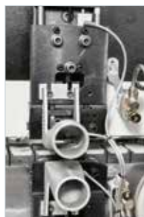
Raschiacolla RC-N Elimina eventuali esuberanti di colla nella giunzione bordo/pannello. Lavorazione nesting.
