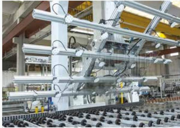
Моторизованные роликовые конвейеры и загрузочные столы (опрокидывные)
