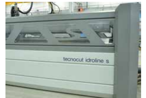
Basamento e portelle: struttura monolitica con vasca in acciaio inossidabile con apertura laterale e protezioni di sicurezza mobili. Cabina di protezione totale dell'area di lavoro con portelle a scomparsa "Totally dry" (std)
