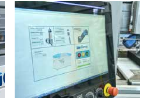
Hardware e Software di gestione dell'impianto di taglio waterjet progettati per offrire un'interfaccia con l'operatore semplice ed intuitiva e consentire una gestione completa di tutte le funzioni del sistema, compreso il controllo della conicità (JDC) per le macchine a 5 assi
