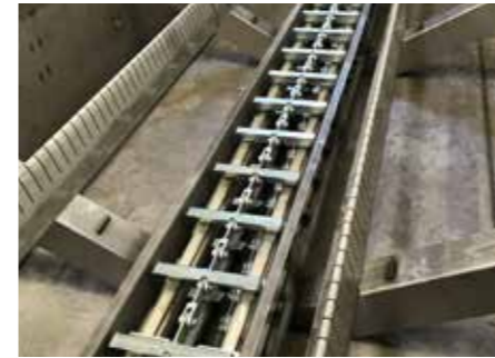
DRAGA: Sistema integrato per la rimozione automatica dell'abrasivo "no maintenance" con protezione della vasca (std)
