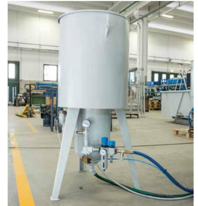
Système d'alimentation pour l'abrasif, avec 2 réservoirs: un avec une capacité de 330 Kg et le second pressurisé, pour alimenter la tête de découpe (doseur électronique). La version à 2 étages est également disponible, capacité 2 000 Kg, permettant d'exécuter de longs usinages sans interruptions dûes au manque d'abrasif, pouvant entraîner des dommages sur le matériaux.
