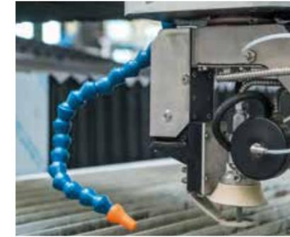
Tête de découpe 5 axes avec technologie IKC - Intelligent Kerf Compensation - . Mouvement efficace de la tête pour réaliser des découpes inclinées et contrôler la conicité.
