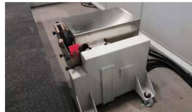
Unité de découpe pour la réalisation d'incisions sur la face inférieure de la plaque, de façon à pouvoir insérer des renforts pour les plans de travail de cuisine. Peut également être équipée d'unité de forage pour les opérations de fixation des plans de travail (cuisine et salle de bains). Les opérations sont gérées automatiquement par la machine et nécessitent l'utilisation du manipulateur à ventouses.
