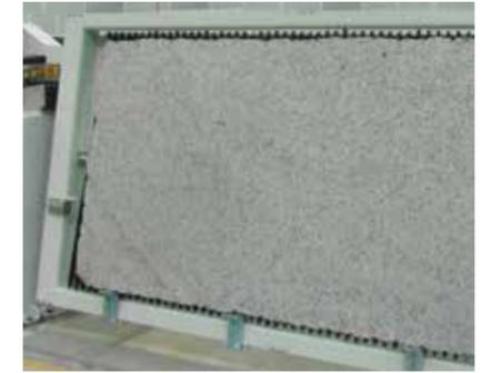
Table basculante hydraulique pour faciliter le chargement vertical des plaques.
