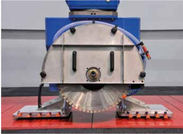
Système à ventouses avec une portée jusqu'à 500 Kg (1 000 Kg en option pour les modèles Brembana Sprint et Gixa), garantissant le déplacement des pièces, même de forte épaisseur.
