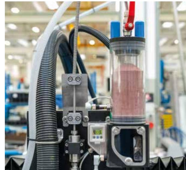
Trémie électronique qui contrôle automatiquement le débit de l'abrasif. S'il devait être interrompu pour quelque raison que ce soit, le système arrêterait automatiquement la découpe afin d'éviter des dommages sur la tête de découpe et d'abîmer la matière. De plus, un capteur de vide relié à la chambre de mélanges relève constamment les variations du débit d'abrasif dans le jet d'eau, fournissant ainsi des informations en temps réel sur l'état de la tête de découpe.
