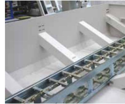
Système de dragage "no maintenance" pour le retrait automatique de l'abrasif. A l'intérieur du réservoir, le système d'évacuation est protégé par des paniers et une cage métallique. Le réservoir est toujours prédisposé pour pouvoir installer le système de dragage dans un second temps.
