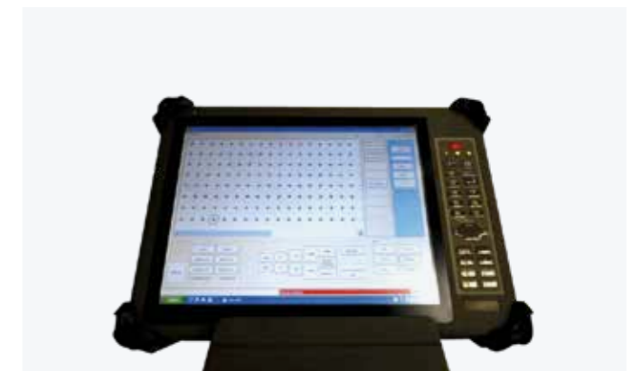
UHF工作台管理控制面板 工作台编程和防撞击控制软件直接集成在CAD/CAM系统中。
