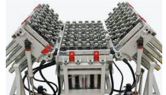
UHF倾斜工作台 工作台中央部分是固定的，两个侧翼部分可以倾斜最大至45°；倾斜度由CN电动数控。最小曲率半径零件加工的最佳解决方案。
