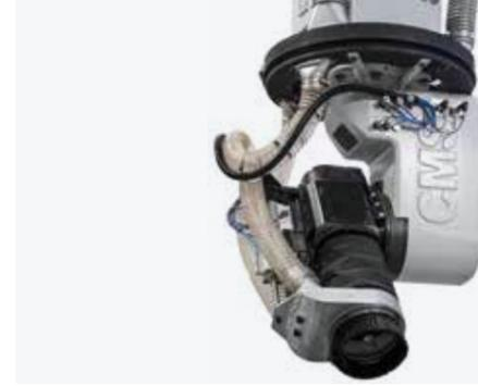
Вытяжной колпак всасывания пыли
