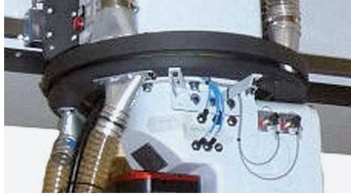
Поворотный коллектор для системы всасывания
