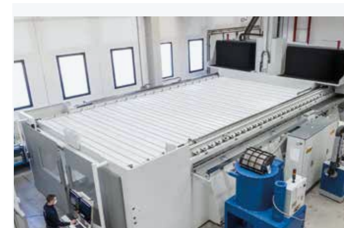
Верхний сильфонный кожух для удержания пыли и стружки
