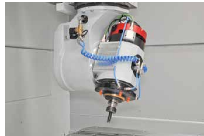
5-осевая режущая головка с технологией прямого привода
