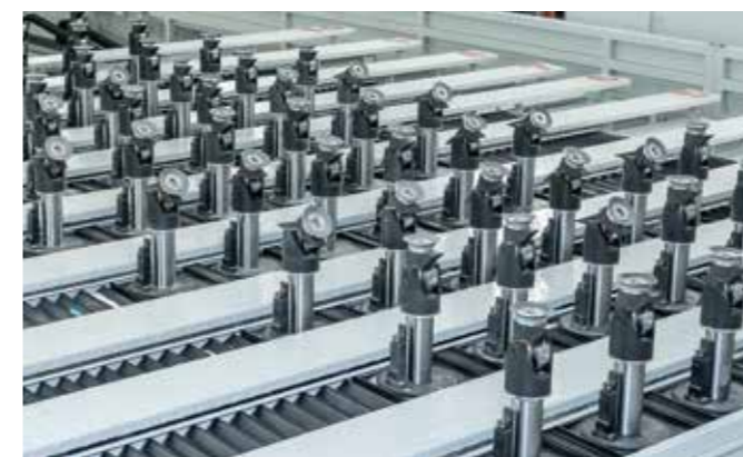
3/5轴 UHF工作台 该系统允许 在加工过程中需要最大支撑的区域对执行器和吸盘进行精准定位。
