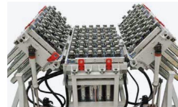
UHF倾斜工作台 工作台中央部分是固定的，两个侧翼部分可以倾斜最大至45°；倾斜度由CN电动数控。最小曲率半径零件加工的最佳解决方案。
