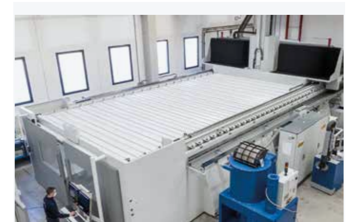
顶部波纹管式封口，可容纳灰尘和切屑
