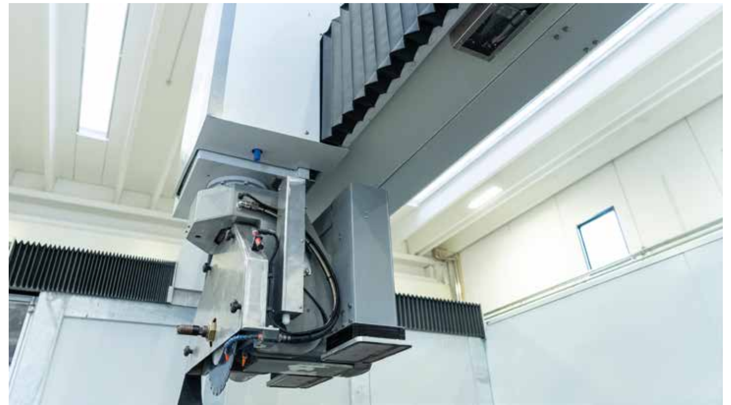
摄像头: 用于获取加工台图像的系统, 它可以加快石材工件的定位并测出板材上可能存在的缺陷
