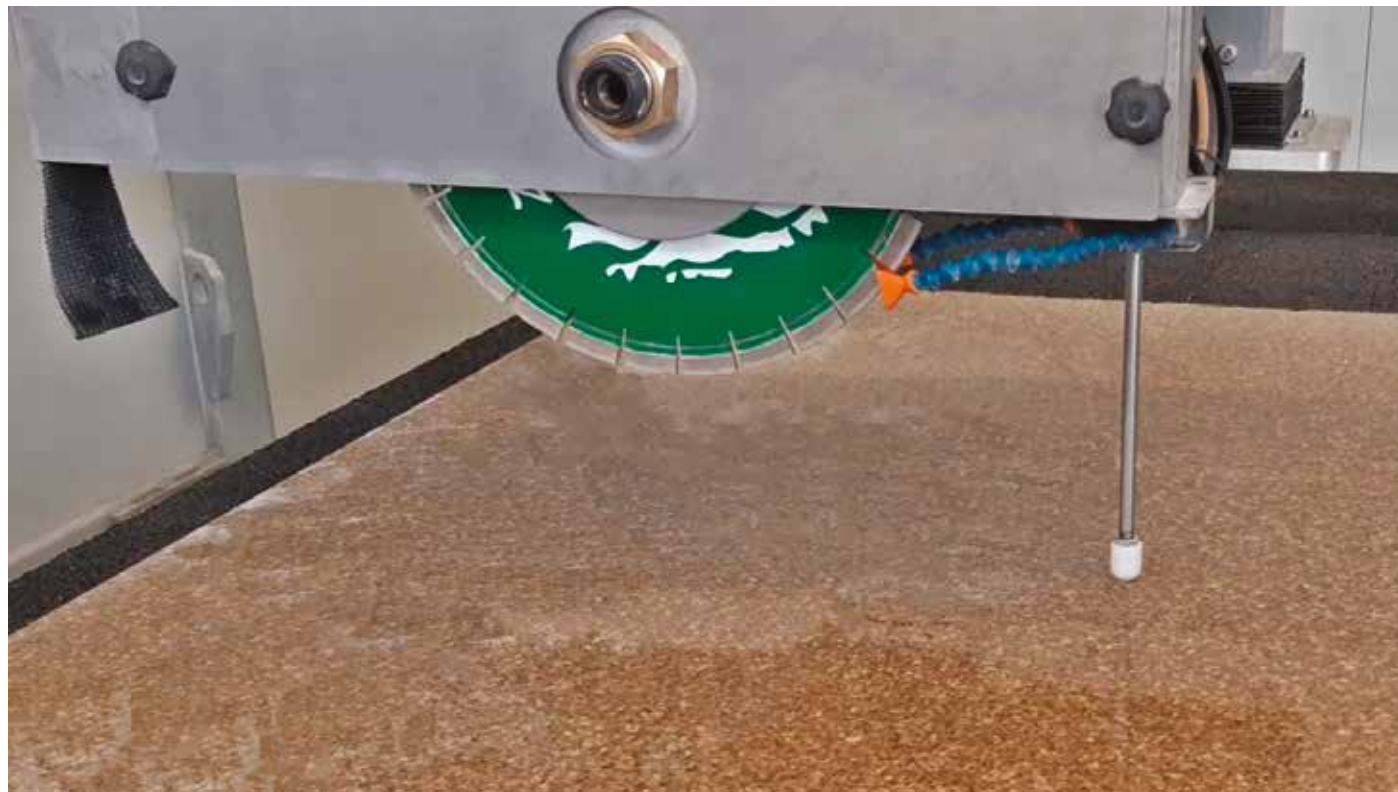
板材厚度检测仪用于自动测量石材或陶瓷工件厚度
