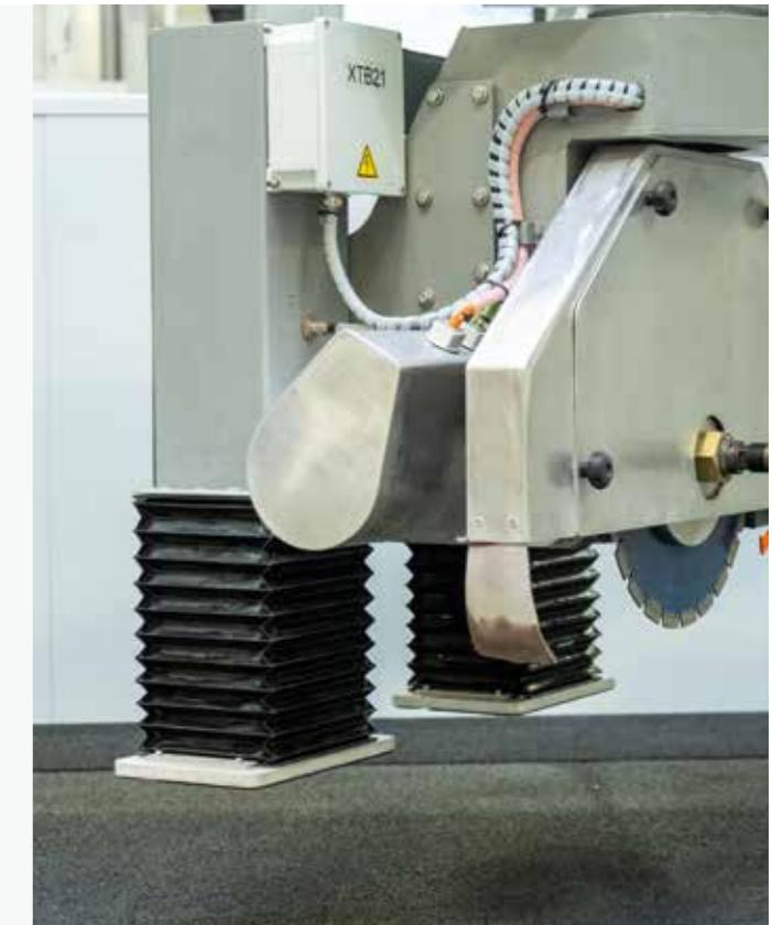
МОЩНЫЙ ЭЛЕКТРОДВИГАТЕЛЬ мощностью 18,6 кВт управляемый инвертором, позволяет регулировать число оборотов от 0 до 5.000. Можно использовать с алмазными инструментами с посадкой 1/2 газ Устройство смены инструмента ручное
