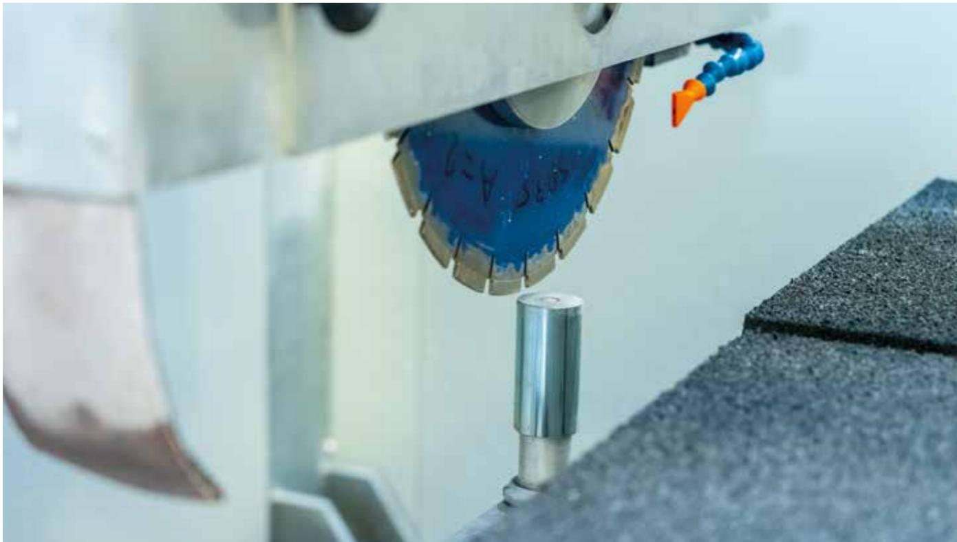
ПРЕДВАРИТЕЛЬНОЕ ИЗМЕРЕНИЕ ИНСТРУМЕНТА для измерения диаметра диска и длины коронок или корончатых сверл
