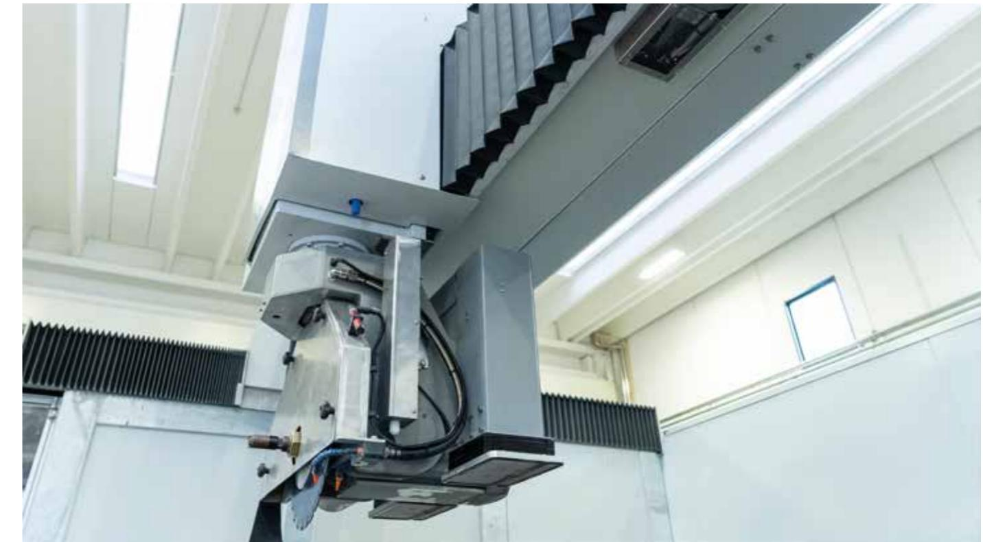
КАМЕРА: система для получения изображений с рабочего стола, позволяет ускорить позиционирование деталей и заметить возможные дефекты
