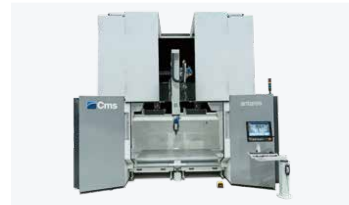
Cabine insonorisée intégrale pour le confinement des poussières, avec éclairage interne.
