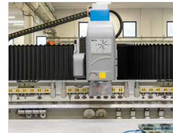
Расположенный под траверсой магазин инструментов на 24 позиции
