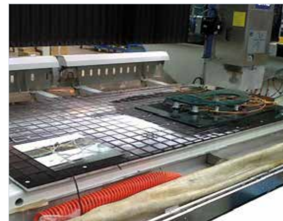
Полностью обрешеченный рабочий стол с вакуумной системой закрепления заготовок
