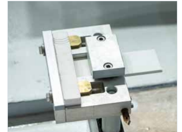
刀具修整套件 借助该设备, 可以按照设定的频率以完全自动的方式修复金刚石。这个完全自动化的系统, 使您能够拥有始终以最高性能在完全安全的情况下工作的刀具。
