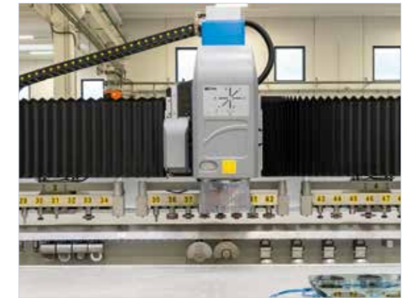
Werkzeughalter unter dem Träger mit bis zu 24 Kegelpositionen
