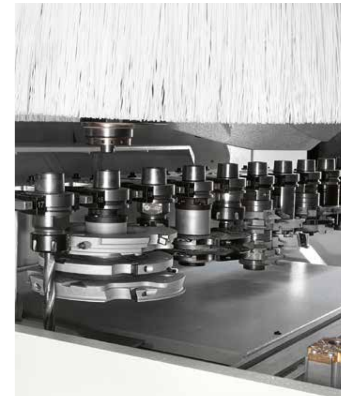
TR 12 12 posiciones Máxima eficacia con el almacén lineal a la derecha de la plataforma de trabajo.
