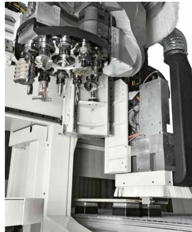
RAPID 12 A BORDO 12 posiciones Almacén circular colocado a bordo de la unidad operativa, realiza el cambio utillaje del husillo principal durante las operaciones de perforación.
