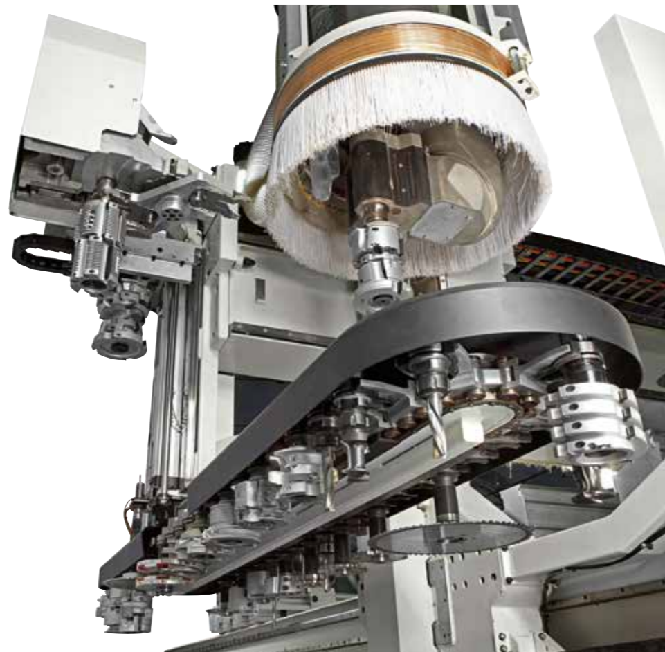
MACH 5 Der Werkzeugwechsel erfolgt in nur fünf Sekunden, was die Ausfallzeiten drastisch reduziert.
