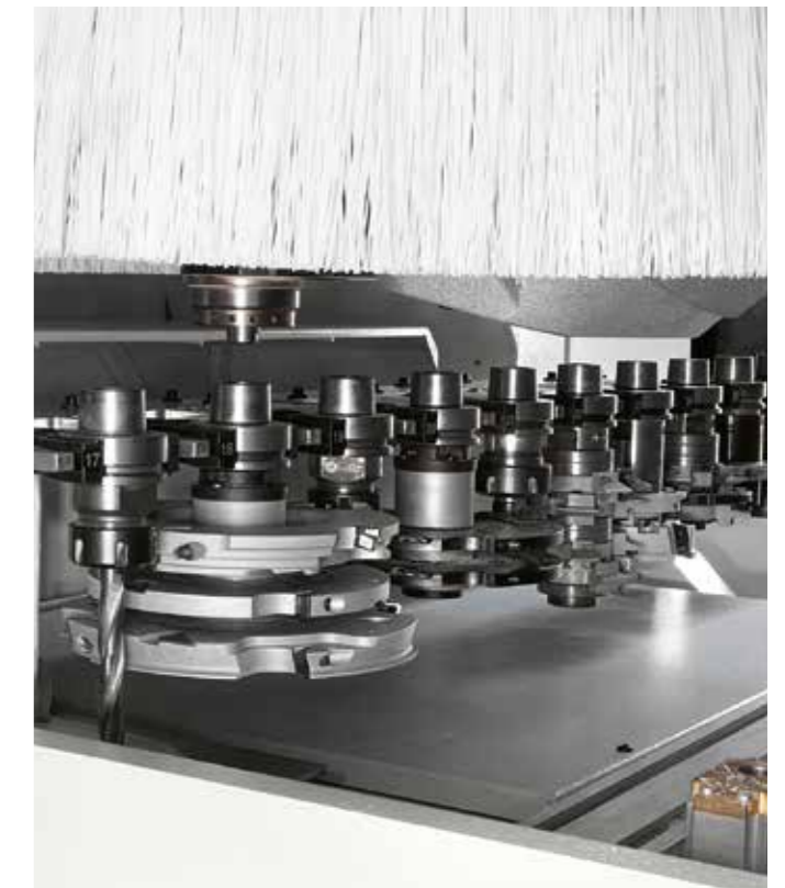
TR 12 12 Positionen Maximale Effizienz mit dem Linearmagazin rechts vom Arbeitstisch.
