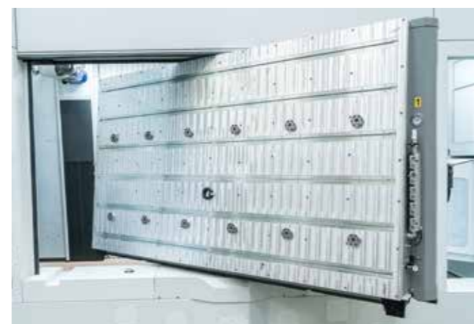
РАБОЧИЙ СТОЛ Возможна адаптация рабочего стола к специфическим потребностям заказчиков (Нулевой маркер, вакуум, Т-образные пазы... и т.п.)
