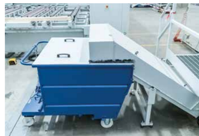
КОНВЕЙЕР ОТВОДА СТРУЖКИ Простота удаления стружки и отходов
