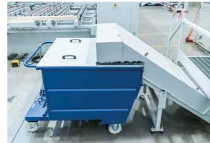
TAPETE TRANSPORTADOR DE LIMALHAS Fácil remoção de pós, limalhas e resíduos vários
