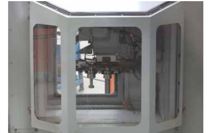
MAGASIN À OUTILS Accès en toute sécurité et protection contre les poussières
