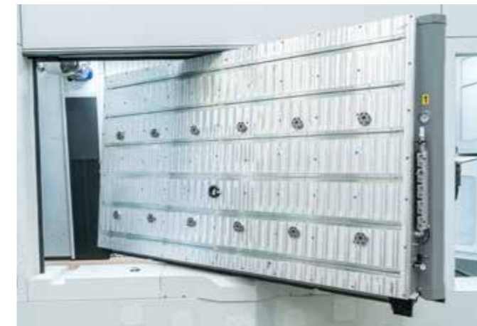
PLAN DE TRAVAIL Le plan de travail peut être personnalisé en fonction des exigences du client (Zero-Point, Vide, T-Slots... etc...)
