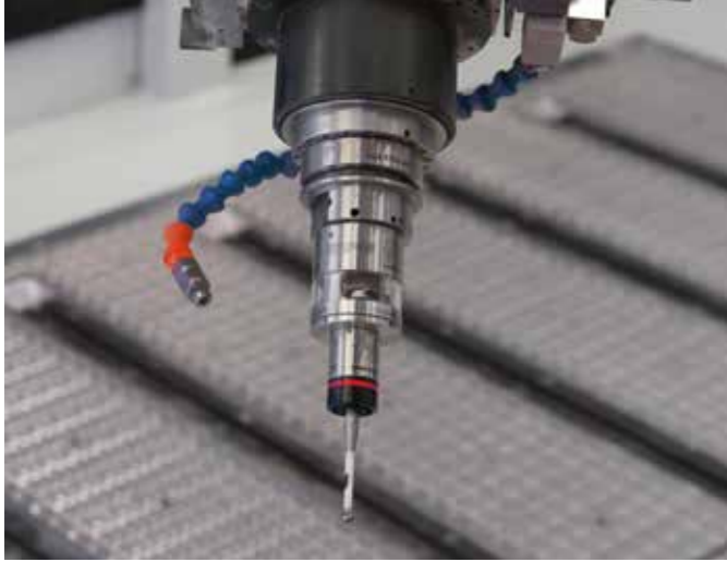
Am Werkzeughalter befestigte Tastvorrichtung mit Funkübertragung des Signals.
