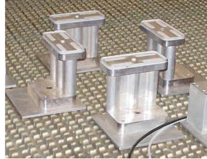
Saugnapfe und Referenzanschlage fur die maximale Flexibilitat beim Einspannen der Werkstucke.
