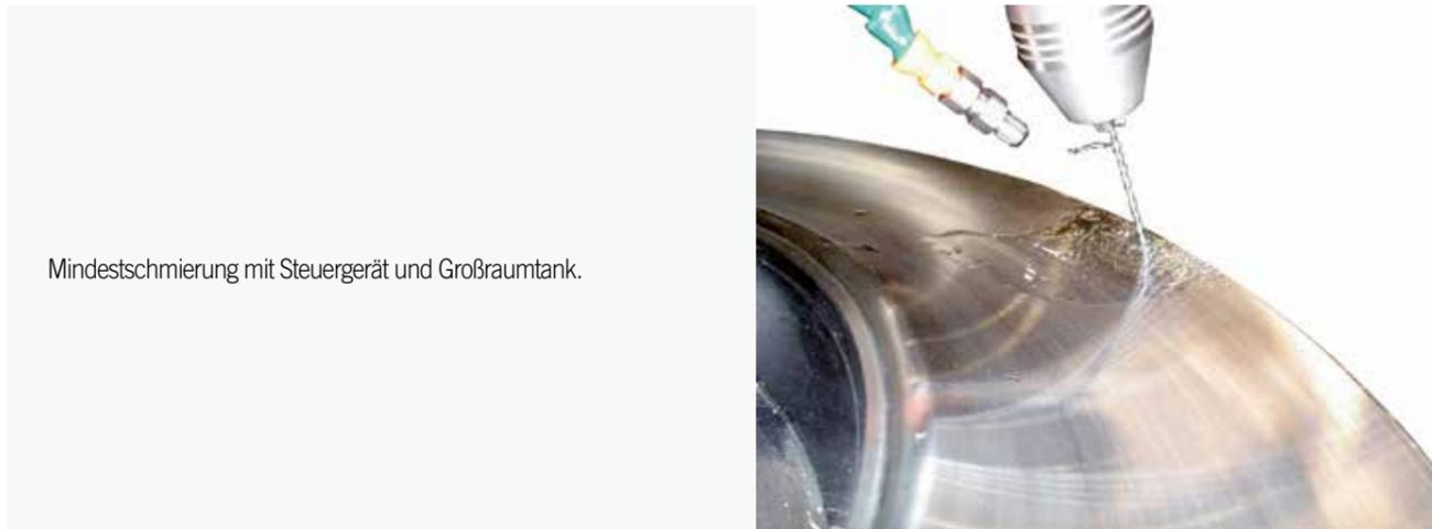
Mindestschmierung mit Steuergerät und Großraumtank.
