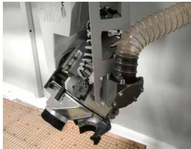
Absaughaube mit 5 Achsen für fokussierte Absaugung im Schneidebereich. Pneumatische Öffnung für Werkzeugwechsel und -entriegelung.
