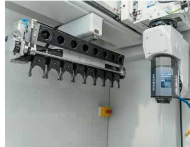
Werkzeugmagazin mit 8 Stationen für Werkzeuge mit hohem Gewicht, das gleichzeitig einen Überdruckschutz für den Werkzeughalter bietet.
