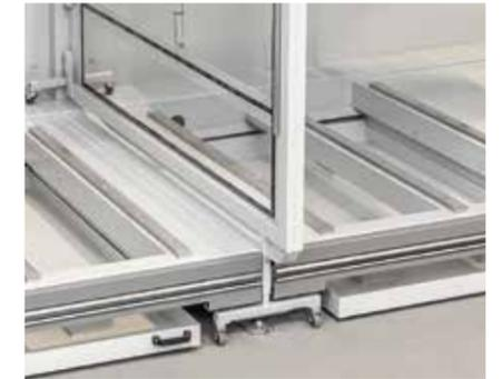
Verschnittsammelsystem mit Behältern auf Rädern mit Frontauszug. Die Behälter, die auch bei geschlossenen Türen entnommen werden können, bieten die ergonomisch sinnvollste, funktionalste und schnellste Lösung für die Gewährleistung eines sauberen und effizient nutzbaren Arbeitsbereichs.
