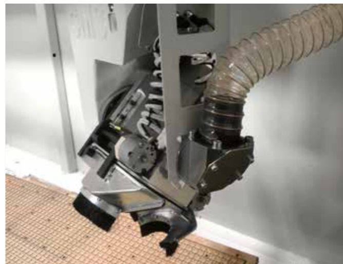
5 轴除尘机罩，对准切割区域进行吸气。更换刀具和释放的气动打开。
