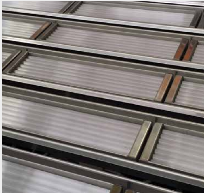
Система обогрева с двумя панелями, верхней и нижней с кварцевым сопротивлением.
