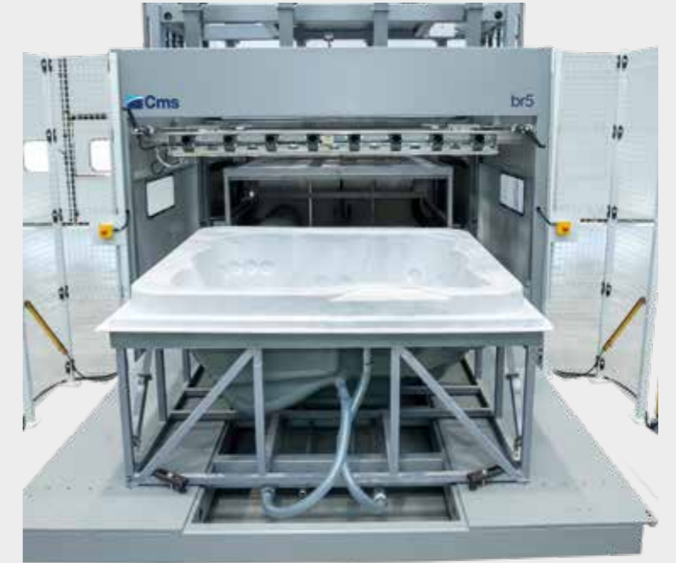
Mesa removível para operações de equipamento e de carga/descarga de material facilitadas
