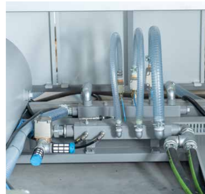
Sistema de vácuo duplo separado para formação da borda e corpo do tanque com reservatório integrado e sistema proporcional
