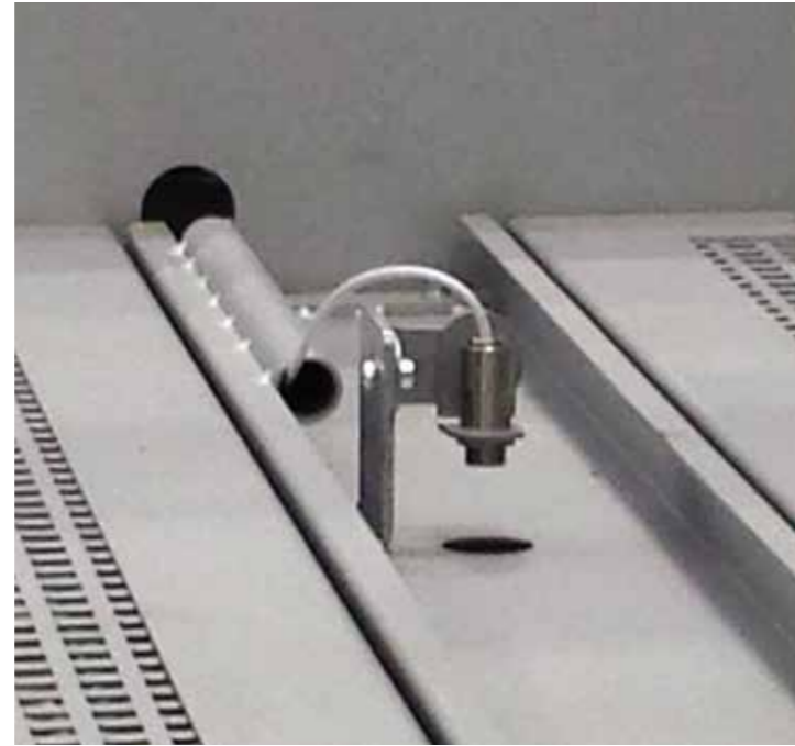
Pirômetro ótico para controlo do aquecimento
