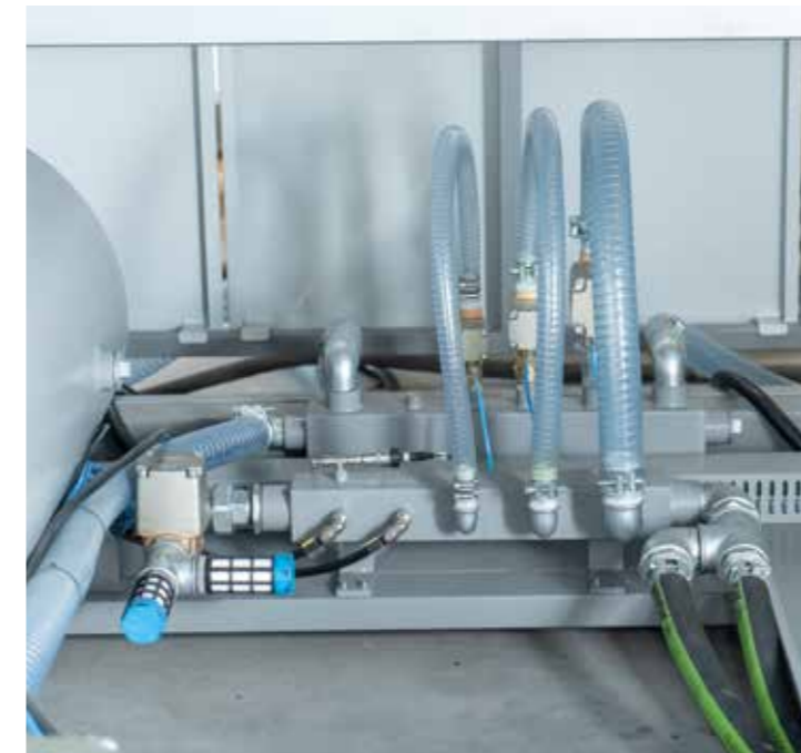
Système de vide double séparé pour le formage des bords et du corps avec réservoir intégré et système proportionnel
