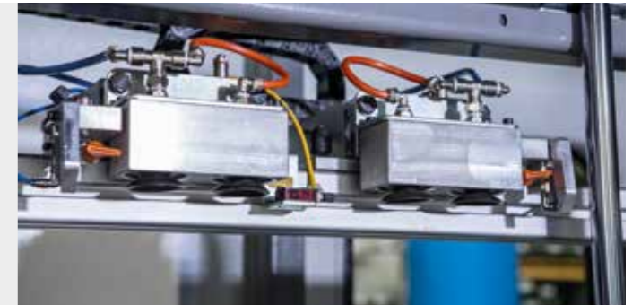
Автоматическая система центрирования листа с обнаружением сдвоенного листа
