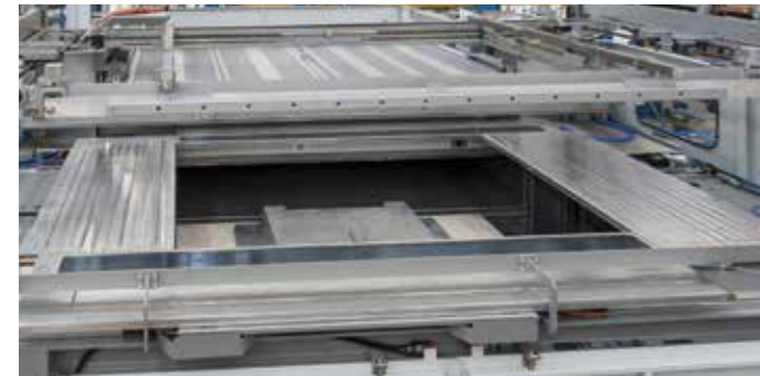
Автоматическое управление плитой регулирования зоны формования
