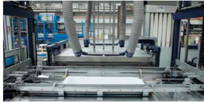
Охлаждение с помощью телескопических рукавов
