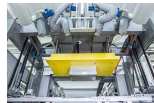
Плита верхней пресс-формы (для формования под давлением)
