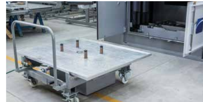
Тележка для замены пресс-форм с встроенным устройством подъема пресс-форм (доступна только для определенных типоразмеров)
