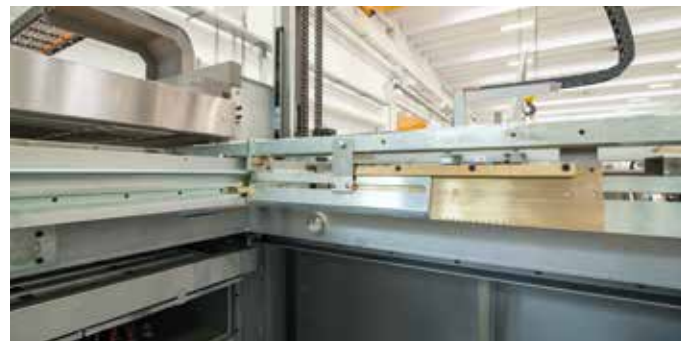
Cadre de serrage avec réglage automatique
