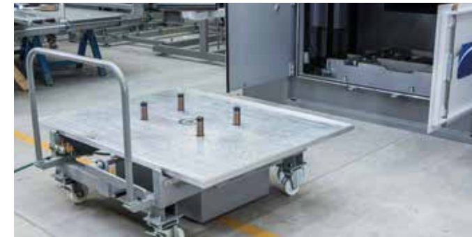
Chariot porte-moules avec système de levage des moules intégré (uniquement disponible pour certains formats)
