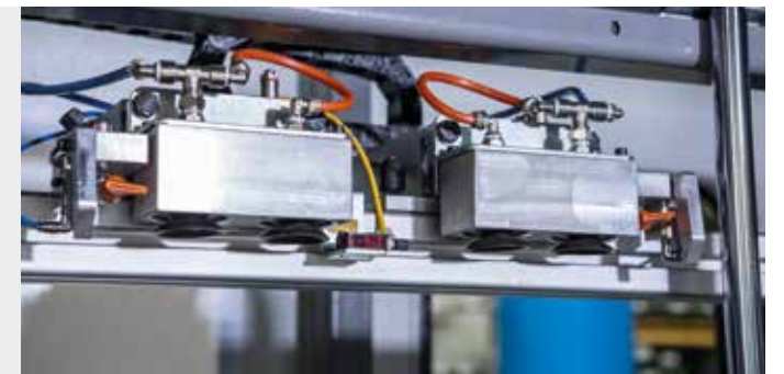
Système automatique de centrage de la plaque avec reconnaissance de double plaque
