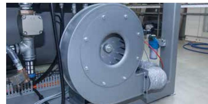
Ventilateur électrique pour emboutissage, vide et extraction proportionnels
