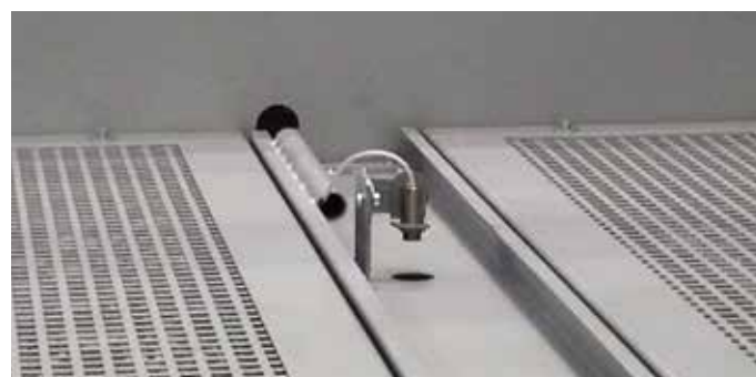
Pyromètre optique pour le contrôle du refroidissement et du réchauffement
